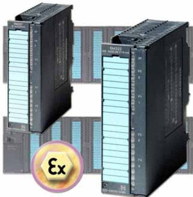
Ex-модули ввода-вывода дискретных сигналов предназначены для организации связи с датчиками и исполнительными механизмами, расположенными во взрыво- и пожароопасных зонах. Модули ввода выполняют преобразование внешних входных дискретных сигналов во внутренние цифровые сигналы контроллера. Модули вывода дискретных сигналов выполняют обратное преобразование. Входные сигналы могут формироваться контактными датчиками, а также датчиками NAMUR, отвечающими требованиям стандарта DIN 19234.
