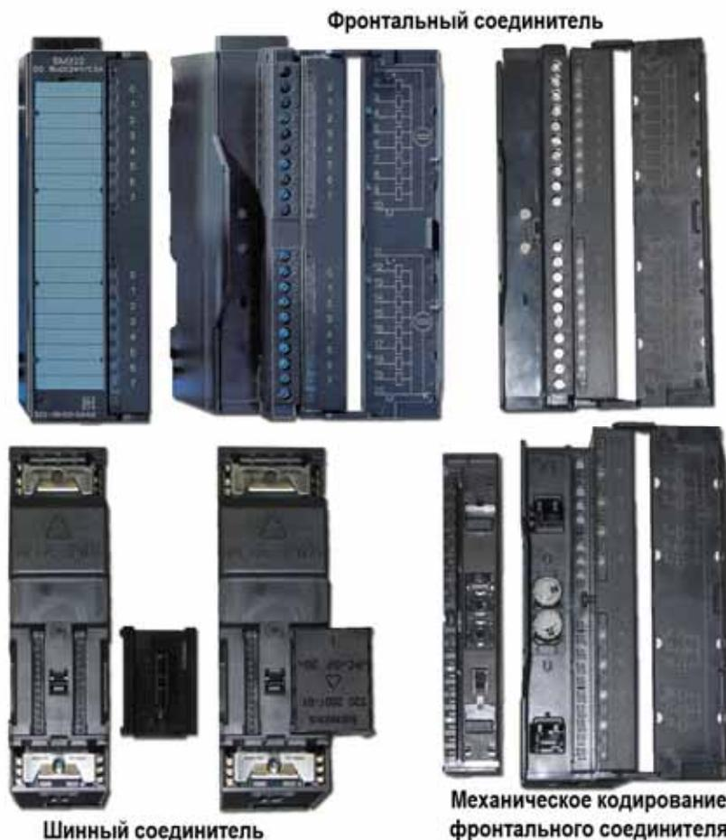
дуля и должен заказываться отдельно. Возможен заказ фронтальных соединителей, обеспечивающих подключение внешних цепей через контакты с винтовыми зажимами или через пружинные контакты-защелки.
