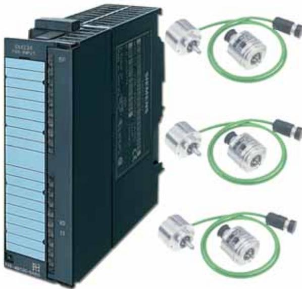
Модуль SM 338 POS предназначен для работы в составе программируемых контроллеров SIMATIC S7-300, а также станций распределенного ввода-вывода ET 200M. Модуль позволяет производить подключение до трех синхронно-последовательных (SSI) датчиков абсолютного перемещения и передавать результаты измерений в центральный процессор.
