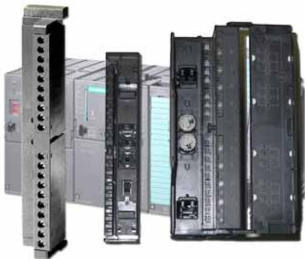
Фронтальные соединители предназначены для подключения к контроллеру внешних входных и выходных цепей. Соединитель подключается к модулю через разъем и закрывается защитной дверцей. Такая конструкция упрощает выполнение монтажных работ и позволяет производить замену модулей без демонтажа всех внешних соединений. В паз защитной дверцы устанавливается этикетка, на который наносится маркировка внешних цепей.
