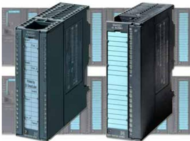
Модули ввода аналоговых сигналов предназначены для аналого-цифрового преобразования входных аналоговых сигналов контроллера и формирования цифровых величин, используемых центральным процессором в процессе выполнения программы. К входам модулей могут подключаться датчики с унифицированными выходными электрическими сигналами напряжения или силы тока, термопары, термометры сопротивления.
