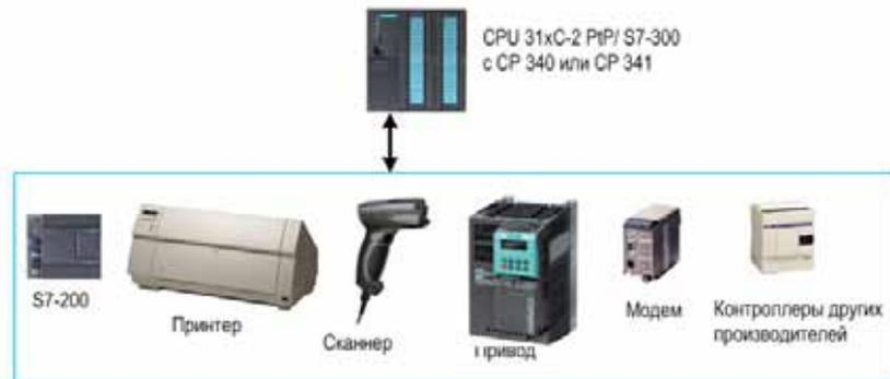
рез встроенные интерфейсы CPU 313C-2PtP/ CPU 314C-2PtP, а также через коммуникационные процессоры CP 340 и CP 341.
