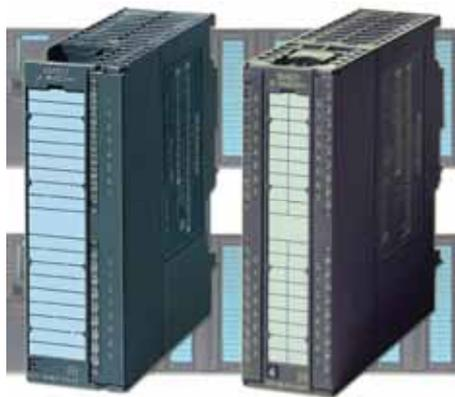
Модули ввода дискретных сигналов предназначены для преобразования входных дискретных сигналов контроллера в его внутренние логические сигналы. К входам модулей могут подключаться контактные датчики или бесконтактные датчики BERO.
